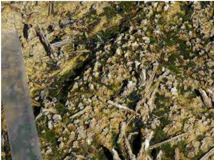
Рис. 1.2. Гипс на поверхности песков под дамбой гидроотвала.
