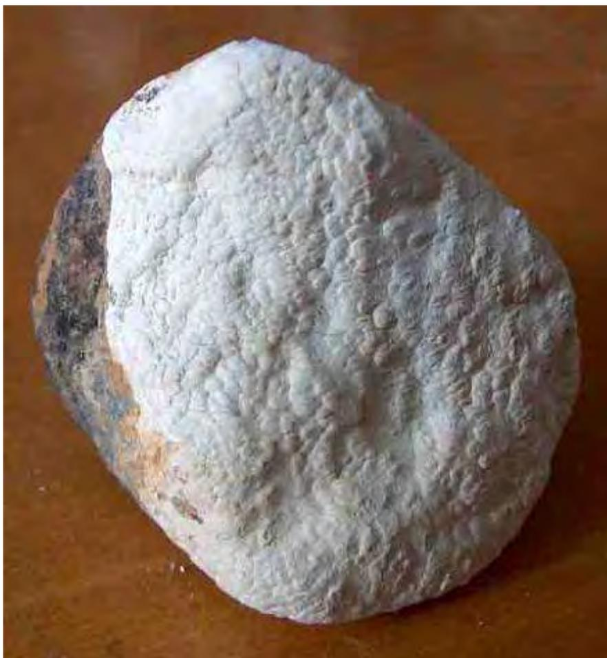
Рис. 1.3. Корка алюмофторидов на гальке из ручья, дренирующего пески гидроотвала
