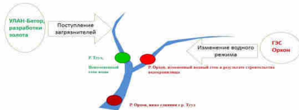
Рисунок 4.7. Концепция моделирования трансформации водного режима и перемещения загрязнителей р. Орхон с помощью программного комплекса HEC_RAS
