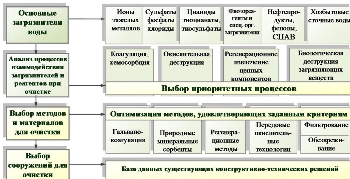
Схема организации физико-химических процессов при очистке оборотных и сточных вод горноперерабатывающих производств
