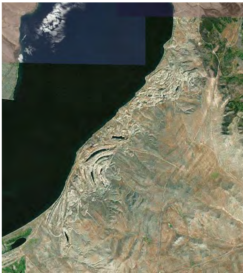
Зураг 2. Галуут нуурын хурэн нүүрсний уурхайн эвдрэлд орсон газрын байдал: Усаар дүүргэгдсэн уурхайн нүх, нүүрс олборлосон хаягдал далан
